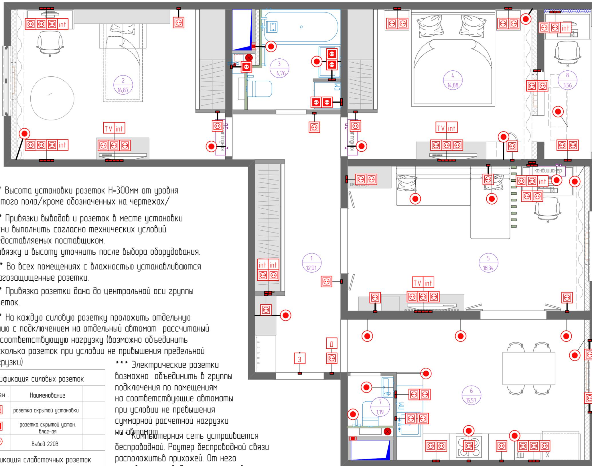
\*\*\* Высота установки розеток Н=300мм от уровня чистого пола/кроме обозначенных на чертежах/
